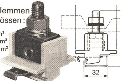
Zum Aufsetzen auf Tragschiene nach DIN 46277/1 mit Verriegelung. Mit unzerbrechlichem Isolierkörper aus Polyamid 6.6, temperaturbeständig von -30°C bis +100°C. Bolzen und Metallgarnitur aus rostfreiem Stahl. Leiter gegen selbstlockern gesichert.
