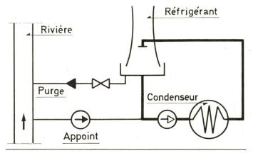
Fig. 2 Circuit à recirculation
