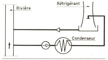
Fig. 1 Circuit à passage simple
