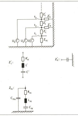
Fig. 9 Simulation und Ersatzschaltung des Teilers
