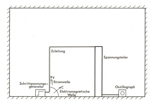
Fig. 1 Rechteck-Prüfkreis zur Bestimmung der Schrittantwort
