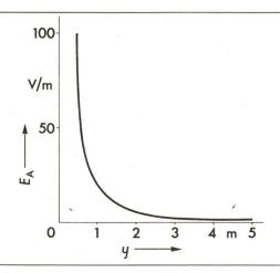
Fig. 8 Die Strahlungsfeldstärke  $E_A$  in Abhängigkeit des Abstandes yzwischen Zuleitung und Teiler, t = r/c
