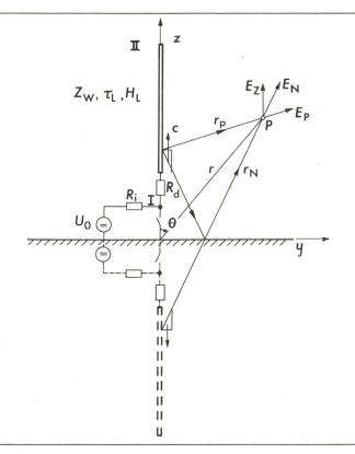
Fig. 3 Vertikale Zuleitung des Rechteckmesskreises
