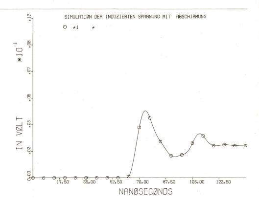
Die Wirkung des Strahlungsfeldes wird in der Weise simuliert, dass in Fig. 9 auf jedes Teilerelement eine Spannungsquelle u<sub>v</sub> geschaltet wird, wobei der Zeitpunkt des Schaltens, t<sub>v</sub>, so liegt, wie sich dies bei der Berechnung der retardierten Strahlungsfeldstärken ergab.
