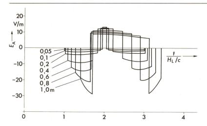
Fig. 5 Die Strahlungsfeldstärke  $E_{\rm A}$  längs des Modellteilers x = 0; y = 1 m;  $Z_w = 315,6 \Omega$ ;  $U_0 = 100$  V;  $R_d = 0$ ;  $R_{\rm i} = 50 \ \Omega; \ H_{\rm L} = 1 \ {\rm m}$ Parameter z = 0.05; 0,1; 0,2; 0,4; 0,6; 0,8; 1,0 m Zeit. H<sub>L</sub> Höhe der Zuleitung Lichtgeschwindigkeit
