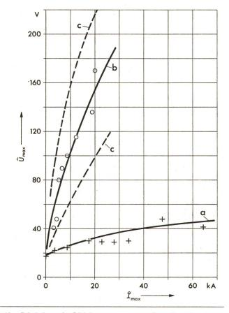
Fig. 12 Scheitelwert der Lichtbogenspannung von Lamellenelektroden nach Variante III im Vergleich zu massiven Kupferelektroden in Funktion des Scheitelwertes der Stromstärke
