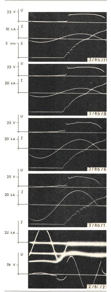
Fig. 11 Oszillogramme des Strom- und Spannungsverlaufes bei Lamellenelektroden nach Variante III
