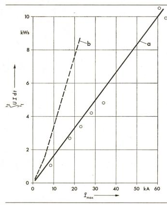
Fig. 13 Schaltenergie von Lamellenelektroden in Funktion des Stromscheitelwertes
