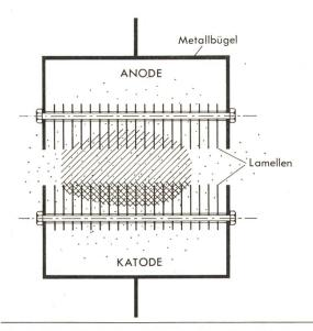
Fig. 6 Schematische Darstellung einer Lamellenelektrode Variante I
