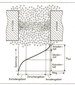
Fig. 5 Ladungsverteilung und Spannungsverlauf bei konzentriertem Vakuum-Lichtbogen
