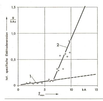
Fig. 2 Spezifische Elektrodenerosion massiver Kupferelektroden in Funktion des Stromscheitelwertes  $\hat{I}_{\max}$
