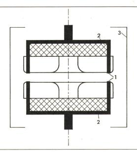
Fig. 8 Schematische Darstellung einer Lamellenelektrode Variante III
