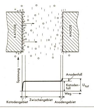
Fig. 4 Ladungsverteilung und Spannungsverlauf bei diffusem Vakuum-Lichtbogen
