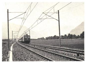
Fig. 1 R-Fl mit nachgespanntem Tragseil, schwenkbaren Rohrauslegern und Y-Aufhängung
