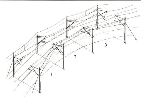
über einige Tragwerkabstände parallel. Auf geraden Strekken und in Kurven mit Radien  $R>1000\,\mathrm{m}$  verwendete man wie im Ausland Parallelführungen über 3 Spannweiten (Felder) nach Fig. 5 und 6 mit Ausleger. In Kurven mit  $R=500...1000\,\mathrm{m}$  sind Abfangjoche (Fig. 7 und 8) erforderlich. Zurzeit wird erprobt und steht zur Diskussion, ob auf Strekken mit  $R>1000\,\mathrm{m}$  einfeldrige Nachspannungen mit Abfangjochen verwendet werden können.
