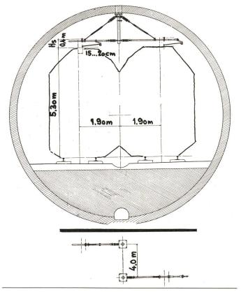
Fig. 10 Norm-Tunneltragwerk. Doppelspur, Heitersberg
