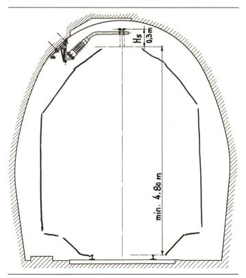
Fig. 11 Fahrleitungs-Tragwerk Simplon einspurig
