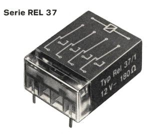
Printrelais mit einer Bauhöhe von 10,5 mm. Die Anschlüsse werden im 1/10"-Rastermass gehalten. 2 oder 4 Doppel-Wechselkontakte stehen bei hoher Lebensdauererwartung und hoher Zuverlässigkeit zur Verfügung.
