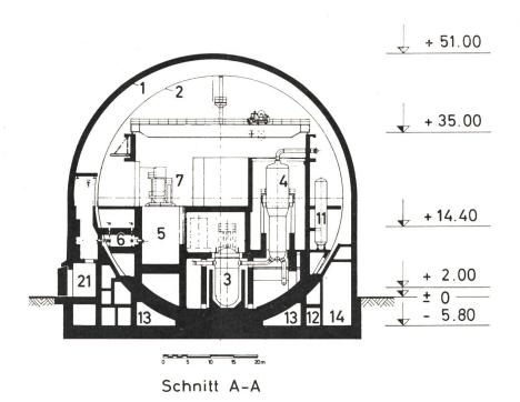
Fig. 4 Reaktorgebäude; Grundrisse und Schnitt
