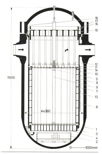
Fig. 5 Reaktordruckgefäss mit Einbauten
