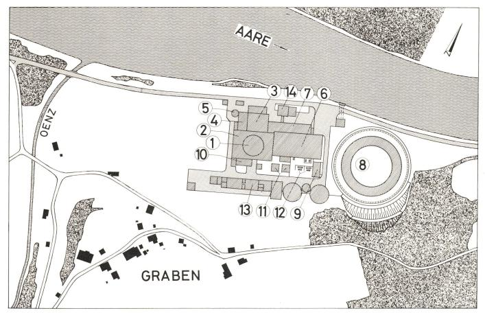
Situationsplan Kernkraftwerk Graben I Fig. 2
