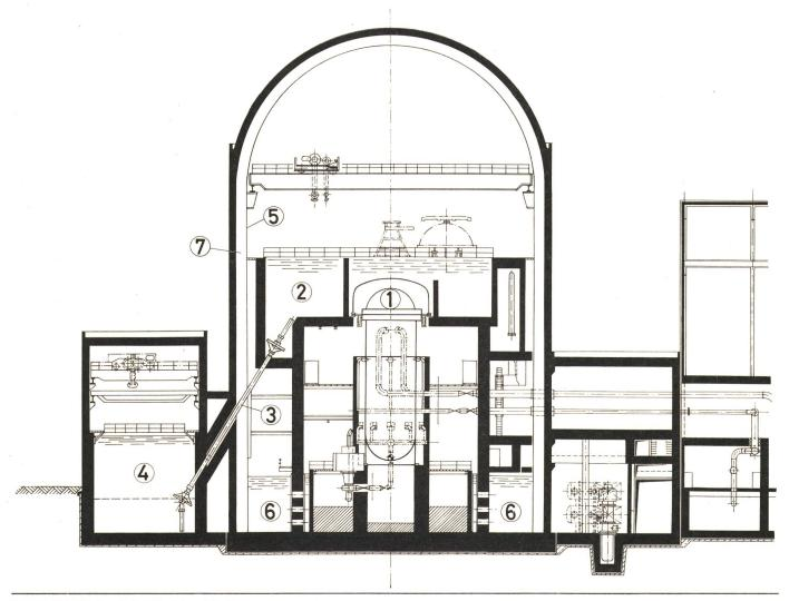
Fig. 3 Schnitt durch das Reaktorgebäude
