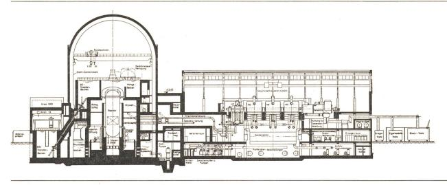
Fig. 2 Kernkraftwerk Leibstadt. Längsschnitt durch die Gebäude
