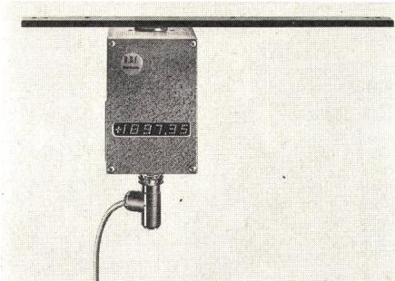
As-Elementen. Der Zähler kann über eine Taste am Abtastkopf zur Nullpunktverschiebung auf Null gesetzt werden. Die Auflösung des Meßsystems beträgt 10 µm, die Genauigkeit des verwendeten Maßstabes ist wahlweise ± 5 µm/m oder ± 10 µm/m. Verfahrgeschwindigkeiten bis 60 m/min sind zulässig. Das Netzgerät, das mit dem Meßsystem über ein dreipoliges, abgeschirmtes Kabel verbunden ist, kann bis zu 20 m entfernt montiert werden.
