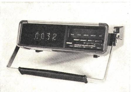
in Labor, Prüffeld und Service. Das neue Gerät gestattet folgende Messungen: Gleichspannungen zwischen 100 µV und 1000 V, Wechselspannungen zwischen 100 µV und 500 V. Gleich- und Wechselströme können direkt bis 1 A gemessen werden. Im kleinsten Bereich beträgt die Auflösung 100 nA. Widerstände können bis max. 10 MΩ gemessen werden.
