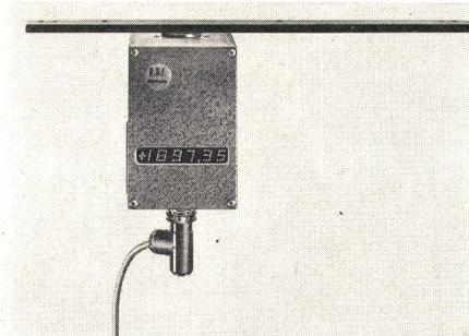
As-Elementen. Der Zähler kann über eine Taste am Abtastkopf zur Nullpunktverschiebung auf Null gesetzt werden. Die Auflösung des Meßsystems beträgt 10  $\mu$ m, die Genauigkeit des verwendeten Maßstabes ist wahlweise  $\pm 5 \mu\text{m}/\text{m}$  oder  $\pm 10 \mu\text{m}/\text{m}$ . Verfahrgeschwindigkeiten bis 60 m/min sind zulässig. Das Netzgerät, das mit dem Meßsystem über ein dreipoliges, abgeschirmtes Kabel verbunden ist, kann bis zu 20 m entfernt montiert werden.
