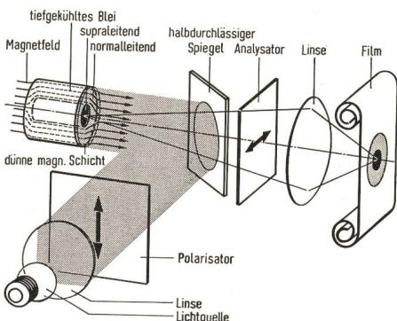
statt. Um diese Bereiche sichtbar zu machen, nimmt man im Forschungslabor der *Siemens AG*, München, den Faradayeffekt, der in bestimmten Materialien eine Drehung des polarisierten Lichtes im Magnetfeld verursacht, zu Hilfe. Analysator und Polarisor sind so eingestellt, dass auf dem Film die supraleitenden Bereiche dunkel, die normaleitenden hell erscheinen.
