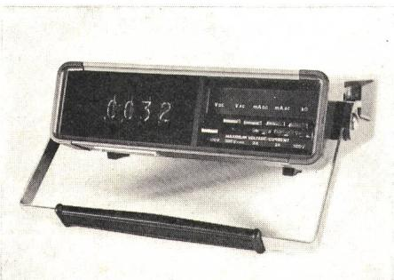
in Labor, Prüffeld und Service. Das neue Gerät gestattet folgende Messungen: Gleichspannungen zwischen 100  $\mu$ V und 1000 V, Wechselspannungen zwischen 100  $\mu$ V und 500 V. Gleich- und Wechselströme können direkt bis 1 A gemessen werden. Im kleinsten Bereich beträgt die Auflösung 100 nA. Widerstände können bis max. 10 M $\Omega$  gemessen werden.
