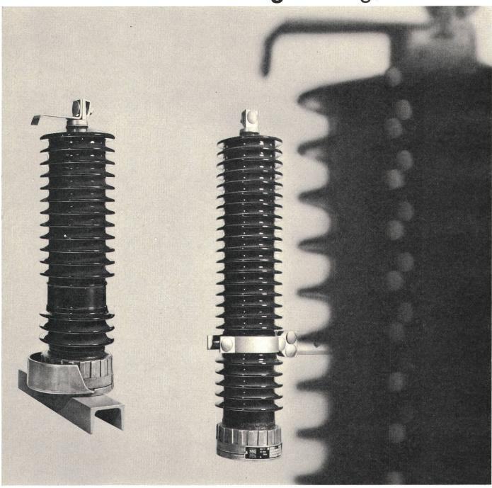
... hat Sprecher + Schuh die neuen Überspannungsableiter der Typenreihe BHF7CA, Grundapparat, und BHF7CC, explosionsfeste Ausführung. Nennableitstrom für beide Typen 5 kA. Mit sieben Baugrössen für 7,5 / 12 / 15 / 19,5 / 24 / 30 und 37,5 kV erreichen Sie die ideale Netzanpassung. Eine feinere Stufung in Zwischenschritten von 1,5 kV steht auf Wunsch zur Verfügung.
