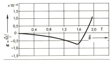
Fig. 2 Wechselfeldmagnetostriktion kornorientierter kaltgewalzter Bleche in Abhängigkeit von der Induktion (nach [3])
