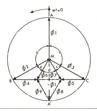
Fig. 4 Zeigerdiagramm der magnetischen Flüsse
