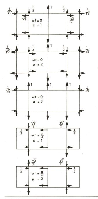
Fig. 5 Momentanwerte der magnetostriktiven Kräftesysteme
