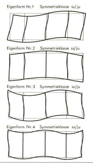
Fig. 6 Die ersten vier Eigenformen des fünfschenkeligen Transformatorkerns
