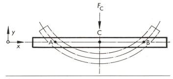
Fig. 1 Erste Eigenform eines frei-frei gelagerten schwingenden Stabes
