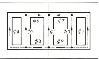
Fig. 3 Magnetische Flüsse  $\Phi$  im Fünfschenkeltransformator
