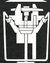
Elektrische Schnellverbindung: Leuchte – Schiene Schiene – Schiene unverwechselbare STECKVERBINDUNG
