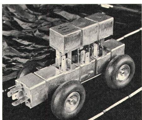
entwickelt. Es ist mit einer würfelförmigen Blechkappe staubdicht abgeschlossen; seine Anschlüsse sind für AMP-Steckhülsen ausgelegt. Die Anordnung der Anschlüsse sowie die Benummerung entsprechen den in der Autoindustrie üblichen Normen.
