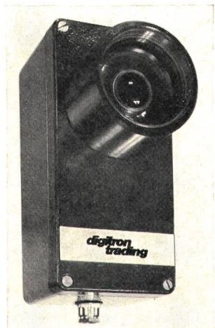
durch ein optisches System gebündelt und auf einen Reflektor geworfen. Die Reichweite von 10 m wird bei der Verwendung des Reflektors R 30 garantiert. Dieser Reflektor ist mit speziellen Tripel-Elementen bestückt, die das Licht auch dann in der Einfallrichtung zurückwerfen, wenn die optische Achse nicht genau ausgerichtet ist.
