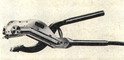
Durchmesser von 2–20 mm<sup>2</sup>. Die gewünschte Bezeichnung wird an der Kontrollöffnung am Kopf der Zange eingestellt und der zu bedruckende Leiter in die Rille der Druckplatten gelegt, wobei ein kurzer Druck die Bezeichnung unverlierbar einprägt. (E. Hess + Cie., Basel)
