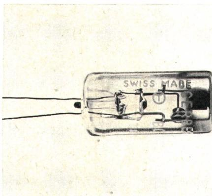
druckten Schaltungen hergestellt. Die beiden Typen mit 200 bzw. 400 V Ansprechspannung ermöglichen äußerst einfache, zuverlässige und damit wirtschaftliche Kippschaltungen zur Pulserzeugung.
