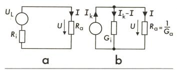
Fig. 2 Die Quellen (a und b) in Fig. 1a und b, aber mit Belastung
