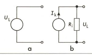
Fig. 4 Gleichwertige Quellen Fig. 1a (mit  $R_i = 0$ , Fig. 1b)
