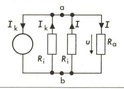
Fig. 5 Geänderte Darstellung der Stromquelle in Fig. 2b
