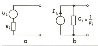
Fig. 1 Spannungs- (a) und Stromersatzbild (b) nach Thévenin  $U_{\rm L}$  Leerlaufspannung  $I_{\rm K}$  Kurzschlußstrom  $R_{\rm i}$  Innenwiderstand  $G_{\rm i}$  Innenleitwert
