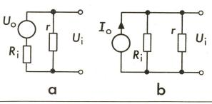
Fig. 6 Die Quellen Fig. 1a und b mit Parallelwiderstand r
