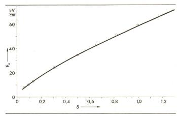
Einsatzfeldstärke  $E_{\rm a}$  bei variabler Luftdichte  $\delta$  gemäss Gl. (14) Fig. 6 Radius des Innenzylinders r = 0,127 cm O Messwerte nach Peek [2], auf Luftdichte  $\delta$  umgerechnet
