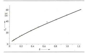
Einsatzfeldstärke  $E_a$  bei variabler Luftdichte  $\delta$  gemäss Gl. (14) Radius des Innenzylinders r = 0,254 cm  $\circ$  Messwerte nach Peek [2], auf Luftdichte  $\delta$  umgerechnet
