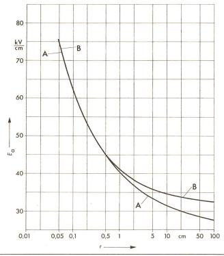
Vergleich der Korona-Einsatzfeldstärke Ea aus Messungen (Kurve A-A) und aus einer Auswertung der Peekformel Gl. (1) (Kurve B-B) für konzentrische Zylinder
