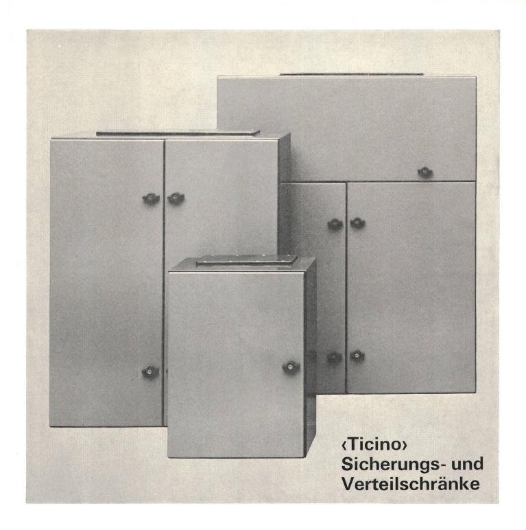
Ausführung staubdicht oder spritz- und strahlwassergeschützt, Stahlblech tiefgezogen, dunkelgrau/hellgrau einbrennlackiert, oben und unten ungebohrte Einführungsplatten, Erdklemmen für Montage von Erdschienen, Gummidichtungen, Gleitschienen, Türen mit Erdverbindungskabel, Drehgriff-Zylinderschlösser. Verlangen Sie unsere ausführliche Dokumentation.
