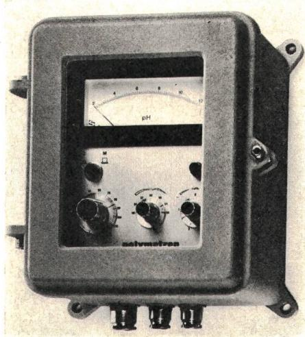
bereichswahl und die Eichung sind einfach und klar definiert. Der grosse, genaue Anzeiger, die Netzlampe und die Bedienungsknöpfe (für Steilheit, Null-Punkt und Temperaturkompensation) sind hinter der Fronttür, sichtbar durch Fenster, jedoch vor unberechtigtem Zugriff geschützt, untergebracht.
