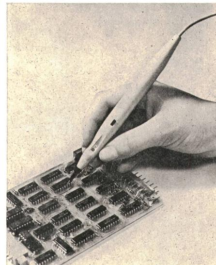
diversen anderen Impulsschaltungen. Zwei Leuchtdioden signalisieren den Logik-Pegel: rot  $\triangleq$  logisch «1», grün  $\triangleq$  logisch «0». Befindet sich der Pegel im undefinierten Bereich (zwischen 0,7 V und 2,4 V), so leuchtet keine der beiden Dioden.
