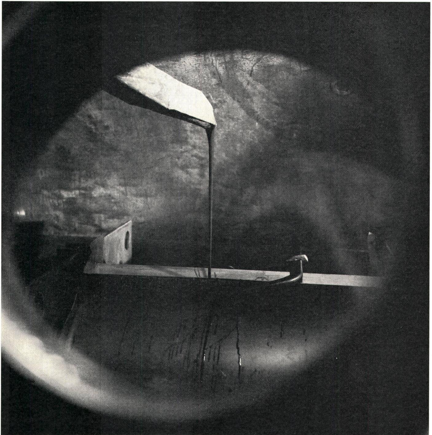
Das Gießharz wird unter Vakuum in die Form gegossen.
