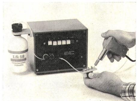
La caractéristique principale du nouvel applicateur est sa simplicité. Il ne comporte pas de réservoir de pression, l'adhésif étant pompé directement dans une bouteille de 100 cm<sup>3</sup> ou de 500 cm<sup>3</sup> au choix, jusqu'à l'ajutage d'enduction, en passant par un tube en caoutchouc au silicium. Les tubes existent en trois diamètres standard de 4 × 2 mm, de 3,5 × 1 mm et de 3,5 × 0,5 mm pour amener un débit convenable d'adhésif à l'aiguille dosuse.
