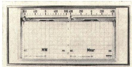
magnetische Linearisierung ergibt eine hochlineare Skala. Die Aufzeichnung erfolgt in rechtwinkligen Koordinaten auf Metallpapier oder mittels eines Tintensystems mit Langzeit-Tintenversorgung auf kopierfähigem Registrierpapier.
