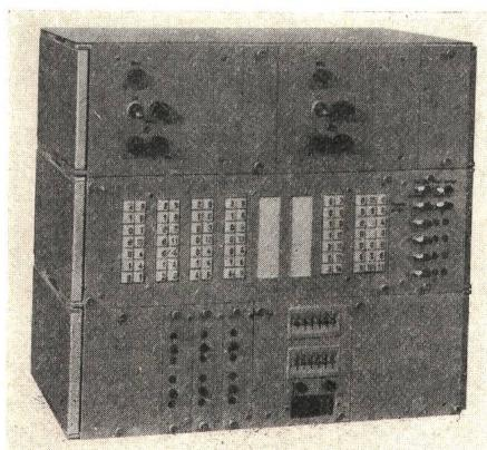
Das System setzt sich aus dem eigentlichen Prozessor, dem Programmspeicher, dem Arbeitsspeicher und verschiedenen Interfaceeinheiten zusammen. Die Interfaceeinheiten bilden das Bindeglied zwischen dem Prozessor und den externen Elementen wie Schalter, Tasten, Temperatur- und Kraftaufnehmer, Schützen, Relais, Lampen, Ventile, Heizungen usw.
