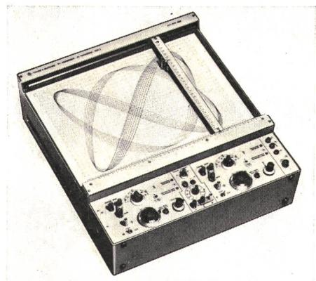
neuartigen elektronischen Einrichtung, die geräuschlos und verschleissfrei den Schreibbereich begrenzt und ausserdem Übersteuerungen anzeigt. Der Ablenkfaktor liegt zwischen 10  $\mu$ V/cm und 11 V/cm, die maximale Schreibgeschwindigkeit über 75 cm/s in jeder Richtung, das Über-schwingen unter 1 mm.
