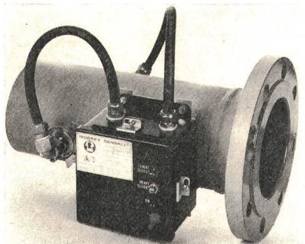
Schwingungen nimmt der Empfänger auf und gibt sie als elektrische Signale an die elektronische Steuereinheit weiter, die beim Erreichen des eingestellten Schwellwertes über ein Relais die Pumpen ausschaltet oder die Schieber umsteuert, damit das verbleibende Trübwasser in das Vorklärbecken zurückgepumpt wird.
