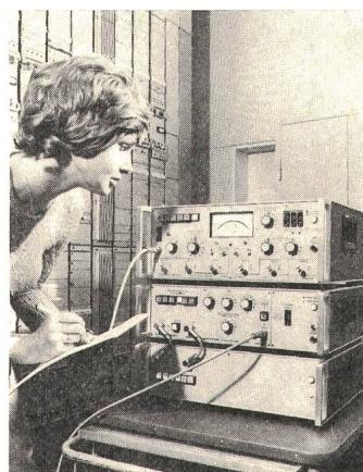
klirrmessplatz K 1077 uneingeschränkt verwendbar. Bei Messungen nach dem NPR-Verfahren wird der Sendepegel unabhängig von der Einfügungsdämpfung der Bandsperren automatisch auf den eingestellten Wert ausgeregelt. Für S/N-Messungen kann der relative Kanalpegel am Empfänger direkt eingestellt werden. Alle Funktionen des Messplatzes sind mit TTL-Pegeln fernsteuerbar.
