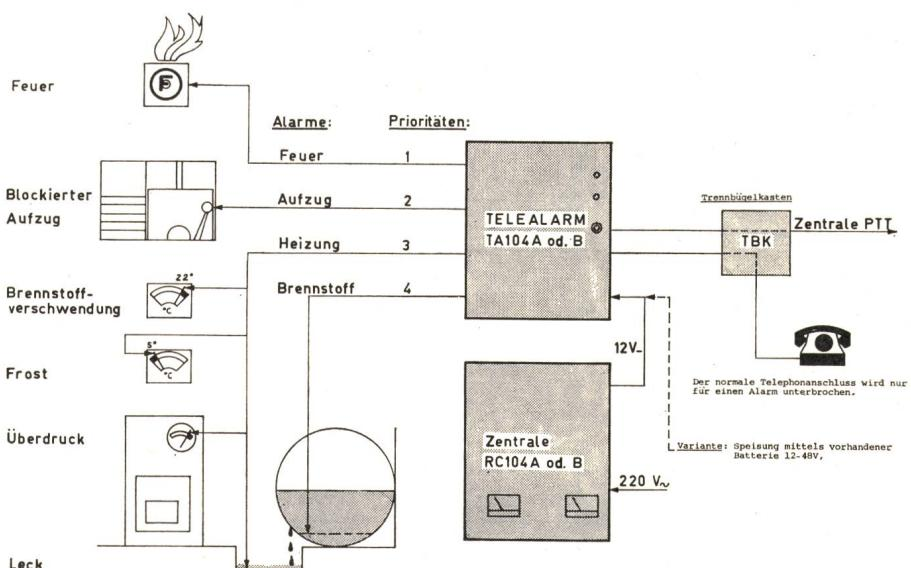
**Telealarm.** Der Apparat wird einfach an eine normale Telefonamtsleitung angeschlossen und ruft sofort alle zum Einsatz vorbestimmten Personen bei Feuer, Einbruch, Überschwemmungen, blockier-
