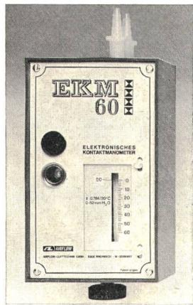
einer in der Höhe verstellbaren Fotozelleneinheit. Der Schaltpunkt ist über den gesamten Messbereich mittels einer Rändelschraube einstellbar. In einem Schenkel des U-Rohres wird ein Kolben auf der Flüssigkeitssäule getragen, der beim Erreichen des voreingestellten Schaltpunktes die Lichtschranke unterbricht und den Schaltvorgang auslöst.
