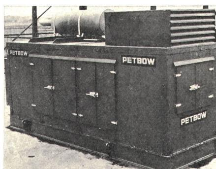
nunmehr für die Schalldämpfung von neuen und bereits bestehenden Anlagen zur Verfügung. Jedes dieser Gehäuse reduziert den in 5 1/2 m Abstand vom Motor gemessenen Geräuschpegel um 30 dB. Damit wird der Geräuschpegel eines Aggregats von 100 kVA Leistung von 86 dB auf 56 dB herabgesetzt, d. h. von «sehr laut» auf den Geräuschpegel, der in einem ruhigen Büro anzutreffen ist.
