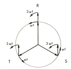
Fig. 2 Spannungsstern: Phasenlage der Amplitude der 3. Harmonischen
