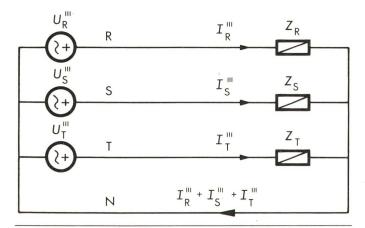
Fig. 4 Ersatzschaltbild für die 3. Harmonische: Generator und Last in einem 4-Leiter-System; Nulleiter mit 3fachem Oberwellenstrom der Polleiter
