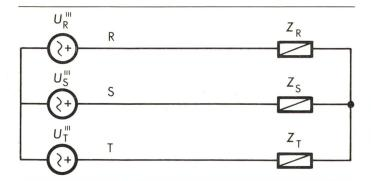
Fig. 3 Ersatzschaltbild für die 3. Harmonische: Generator G und Last Z in einem 3-Leiter-System (vereinfacht)
