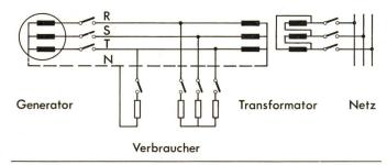
Fig. 1 Niederspannungsnetz, gespeist von einem Transformator und Generator
