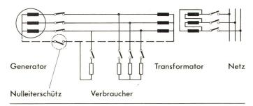
Fig. 5 Niederspannungsnetz, von einem Generator über einen Transformator gespeist
