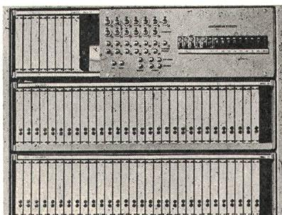
Die Steckkarten werden in Normmagazinen zusammengefasst, die in Schwenkräumen oder feste Gestellrahmen montiert werden können.
