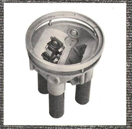
die bodenbündige Einbaudose mit Telefon- und Starkstromanschluß, fertig verlegt. Sie ist speziell für die Installation im Großraum geschaffen. Das neue Bodendoseninstallationssystem garantiert die absolute Flexibilität der Energieanschlüsse wie Telefon-, Starkstrom-, Schwachstrom- und Pneumatikanschlüsse. Verlangen Sie die ausführliche Dokumentation Bodendose zu 20.51.1
