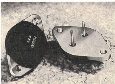
Gehäuse. Die neuen Elemente stimmen elektrisch mit den bisherigen Typen überein und sind in beiden Polaritäten mit 5 und 10 % Toleranz erhältlich.
