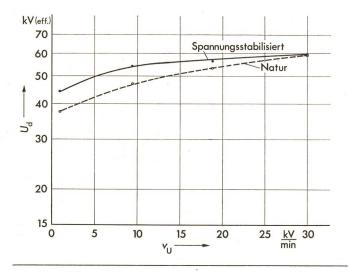
Fig. 2 Einfluss der Spannungsanstiegsgeschwindigkeit  $\nu_{\rm u}$  auf die Durchschlagfestigkeit  $U_{\rm d}$  von PE
