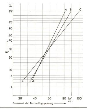
Fig. 5 Einfluss der Vorbeanspruchung auf die Wechselspannungsdurchschlagwahrscheinlichkeit Bezeichnungen siehe Fig. 3 und im Text
