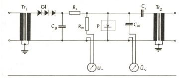
Fig. 7 Versuchsanordnung bei Gleichspannungsüberlagerung
