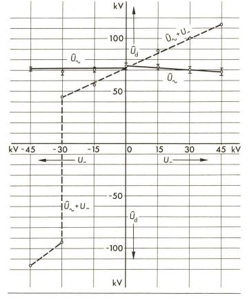
Fig. 8 Einfluss der Gleichspannungsüberlagerung auf die 50-Hz-Durchschlagsfestigkeit
