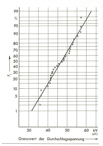
Fig. 3 Durchschlagwahrscheinlichkeit bei Wechselspannungsbeanspruchung
