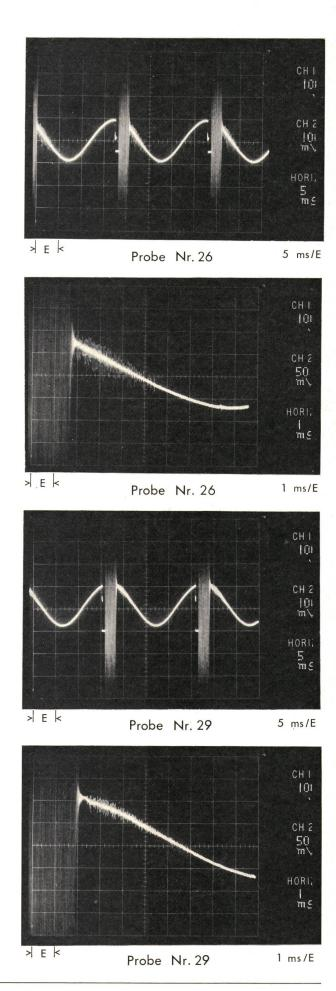
Fig. 6 Durchschlagsmoment bei Wechselspannungsbeanspruchung  $\ E$  Zeitbasiseinheit
