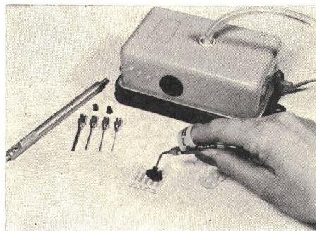
Vakuumgenerator erzeugt einen Unterdruck von max. 350 mm Quecksilbersäule. Dieser Unterdruck wirkt über den Vakuum-Plastikschauch auf an den Sauggriff aufgesteckten Saugspitzen bzw. Saugnäpfchen. Das Ansaugen und Freigeben der Teile geschieht einzig durch Abdecken und Freilassen eines Luftloches am Sauggriff mit dem Finger. (Kager-Verfahrenstechnik, Frankfurt/M.)
