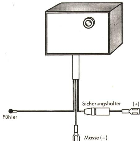
wird, dass sich die Gefahr nun verstärkt hat und erhöhte Vorsicht geboten ist. Beim Erreichen des Gefrierpunktes brennt die Lampe voll rot. (Metronic AG, Zürich)
