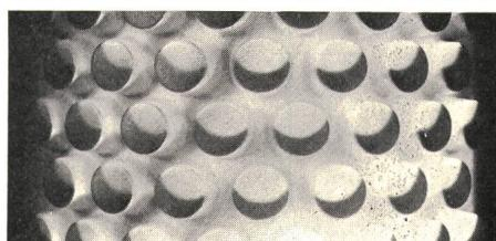
Vorteil für die Praxis: Beim Schneiden, Spalten und Stanzen entsteht kein «Sägemehl», was für die absolute Sauberhaltung von Packgut zum Beispiel für optische oder elektrische Geräte besonders wichtig ist. Der Schaum kann auch im Bauwesen, so als Fugenhinterfüllungen, Vorlegebänder usw. und im Automobilbau eingesetzt werden.
