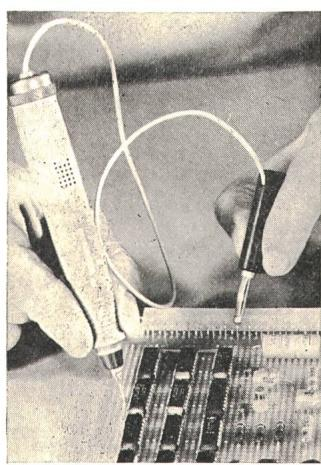
Kontakt der Spitzen miteinander. Ganz deutlich ist der Unterschied in der Tonhöhe bei  $50\ \Omega$  wahrnehmbar. Bis etwa bei  $500\ \Omega$  wird der Ton tiefer, darüber hinaus steigt er an, ist aber etwas leiser. So lassen sich die bei der Prüfung angezeigten «Durchgänge» durchaus im Widerstand unterscheiden. Die Ansprechgrenze des Gerätes liegt bei 80 bis  $100\ k\Omega$ .
