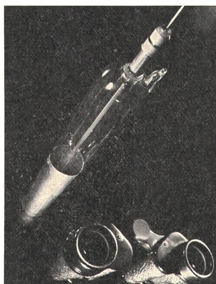
ses Bauelement liefert bei 1 mW Ausgangsleistung einen roten Lichtstrahl mit einer Wellenlänge von 632,8 nm, der in verschiedenen opto-elektronischen Systemen und Geräten Aufzeichnungs-, Abtast-, Steuer- sowie Schaltvorgänge durchführen kann.
