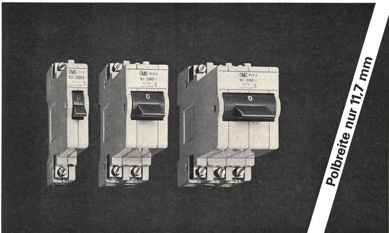
*Der Picomat ist der ideale Sicherungsautomat in Kleinmaschinen-Steuerungen und Wohnverteilern. Schnappbefestigung, vielseitiges und praktisches Montage- und Anschluss-Zubehör erlauben Ihnen, leichter und sauber zu installieren. Alle Ausführungen für Leistungs- und Geräteschutz sind bis 25 A 380 V~ erhältlich; bei 380 V~ beträgt die Abschaltleistung 3000 A. Der Typ PLV kann neu mit einer 100 A-Vorsicherung verwendet werden.
