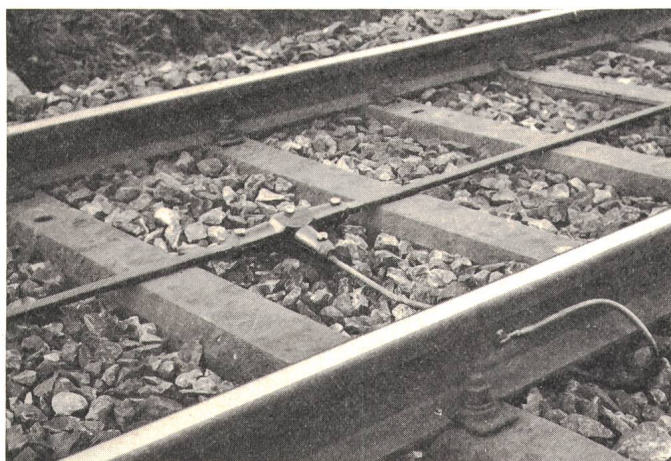
Fig. 9 Abzweigarmatur eines Linienleiter-Kabels, in welcher eine gedruckte Schaltung mit dem Phasenkern-Transformator direkt eingegossen wurde
