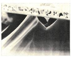
P-Germanium-Tunneldiode AEY 30 A. Bei 6 GHz liegt die Gesamtverstärkerrauschzahl um 5 dB. Der pn-Übergang ist durch elektrochemisches Ätzen am Schnittpunkt der beiden einander zugewandten keilförmigen Strukturen unterhalb des Matallisierungsfingers entstanden. (Vergrösserung.)
