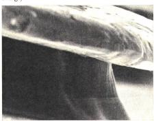
Si-Impattdiode in passivierter Upsidedown-Technologie. Die Struktur liefert 300 mW Ausgangsleistung bei 15 GHz und  $\eta=6\,^{0}/_{0}$ . Der aktive Kristall (Gesamtdicke 15  $\mu$ m) befindet sich zwischen der integrierten Wärmesenke (unten) und dem Goldkontakt (oben). (Vergrösserung.)
