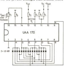
auf der Diodenreihe den Zeiger darstellt. Erstmals eingesetzt wird der UAA 170 für die Stationsskalen von Autoradios: Die Abstimmdiode des Empfängers liefert der integrierten Schaltung direkt die Anzeigewerte des eingestellten Senders.
