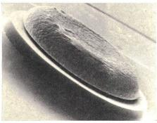
Si-Speichervaraktor in Mesatechnologie. Oberfläche mit thermischem Oxid passiviert. Dieser Aufbau ergibt bis zur Durchbruchspannung geringe Sperrströme (im Subnanoampère-Bereich). (Vergrösserung.)
