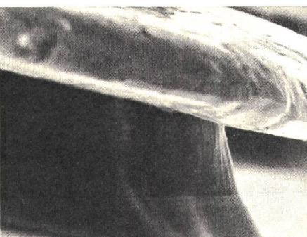
Si-Impattdiode in passivierter Upside-down-Technologie. Die Struktur liefert 300 mW Ausgangsleistung bei 15 GHz und  $\eta = 6\%$ . Der aktive Kristall (Gesamtdicke 15 µm) befindet sich zwischen der integrierten Wärmesenke (unten) und dem Goldkontakt (oben). (Vergrößerung.)
