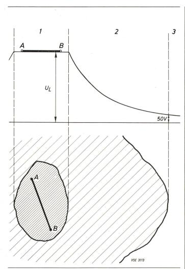
Fig. 3 Eine Leitung A–B, die vollständig innerhalb des Werkbereiches verläuft, greift am Boden keine Spannung ab
