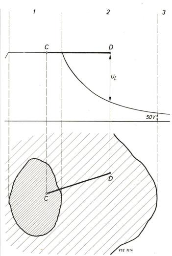
Fig. 4 Die Leitung C-D (mit der Anlageerdung verbunden) greift im Übergangsbereich die Spannung  $U_{\rm L}$  ab, durch die die Leitung und die Ausrüstungen im Punkt D gefährdet werden
