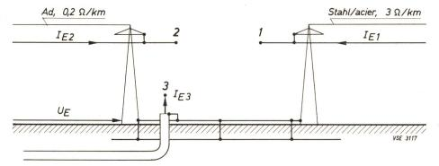
Fig. 7 Abhängikeit der Erdungsimpedanz vom Weg des Erdschlußstromes
