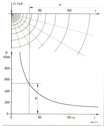
Fig. 1 Erdpotential bei einem Strom von 1 kA, der konzentriert in einen Boden von  $\varrho=100~\Omega m$  eintritt
