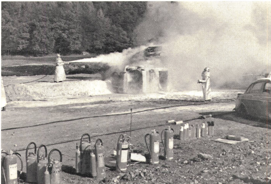
Ersticken der Flammen mit Löschstaub Etouffement du feu par un appareil à poudre
