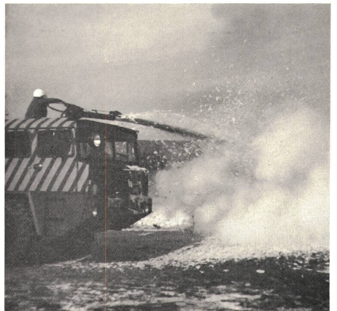
Ersticken der Flammen mit Löschstaub Etouffement du feu par un appareil à poudre
