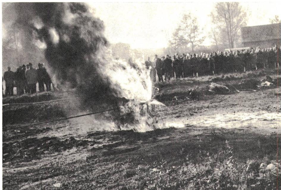
**Löschversuch bei geplatzter Benzinleitung**
