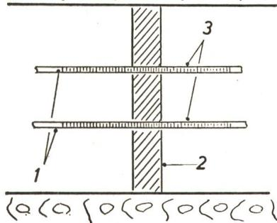
**Cloison avec enduit de «Flammastic»**
