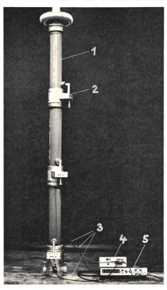
Fig. 3 Versuchsmodell zur Gleichspannungsmessung mit Überlagerung von Teilspannungen
