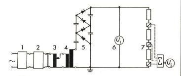
Fig. 5 Schaltbild der 300-kV-Gleichspannungsanlage
