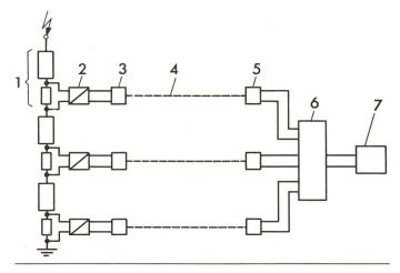
Fig. 2 Blockschaltbild eines Meßsystems mit digitaler Messwertübertragung über Lichtleiter Erläuterungen siehe im Text
