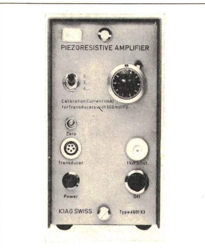
toute l'étendue un signal de 500 mV exactement. Cette tension de sortie élevée peut être directement utilisée. Dans certains cas, un signal plus puissant est toutefois néces- saire et doit par conséquent être amplifié.
