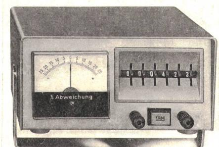
Tester ist übersichtlich aufgebaut und einfache zu bedienen. Der grosse Messbereich weist eine ermüdungsfreie ablesbare Skala auf und erschliesst ein breites Anwendungsgebiet.
