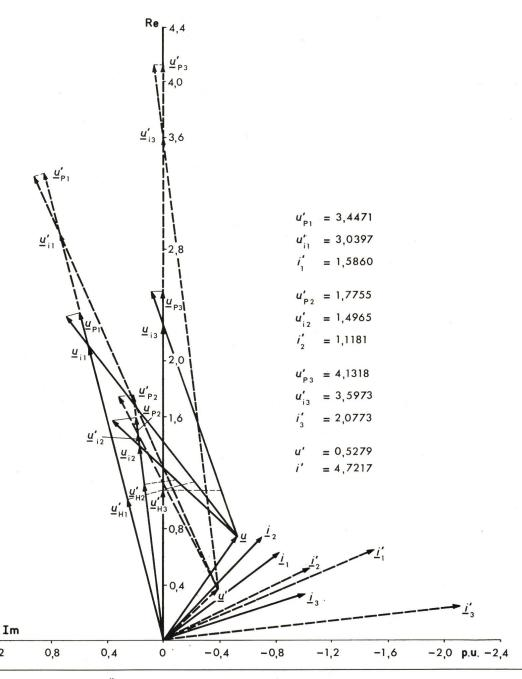
Fig. 4 Zeigerbild bei plötzlicher Änderung der Lastimpedanz z<sub>B</sub> in z<sub>B</sub>'
