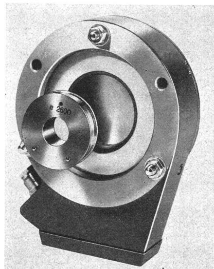
Erreicht oder überschreitet die zu überwachende Welle die fest eingestellte Drehzahl, so verdrehen die Fliehkraftbacken des Rotors einen im Stator eingebauten Mitnehmerring. Der Mitnehmerring seinerseits betätigt, unabhängig von der Drehrichtung, einen robusten Schnappschalter mit hoher Schaltleistung.
