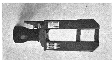
Die *Rauscher & Stoecklin AG*, Sissach, hat nun einen Spezial-Zangenstromwandler auf den Markt gebracht, der gestattet, jedes einpolige Kabel im Anschlussraum der Tribloc-Elemente einzeln zu umfassen. Dieser wurde entwickelt für die Klasse 1 bei 400/5 A mit 10 VA bzw. bei 600/5 A mit 15 VA Leistung.
