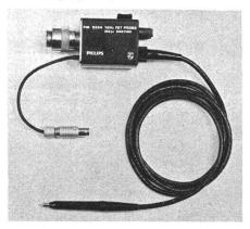
den Abtast-Oszillographen PM 3400, der auch die 24-V-Speisung des Messkopfes übernimmt. Für Messgeräte ohne diese Speisespannung ist ein gesondertes Speisegerät vorgesehen. Das Messkabel ist 1,5 m lang. Grösse und Gewicht unterscheiden diesen aktiven Messkopf kaum von den üblichen passiven Messköpfen.
