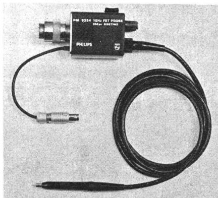
den Abtast-Oszilloskopen PM 3400, der auch die 24-V-Speisung des Messkopfes übernimmt. Für Messgeräte ohne diese Speisespannung ist ein gesondertes Speisegerät vorgesehen. Das Messkabel ist 1,5 m lang. Grösse und Gewicht unterscheiden diesen aktiven Messkopf kaum von den üblichen passiven Messköpfen.
