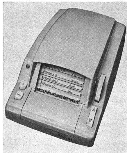
einem Knopfdruck. Alle neuen *Magicall* von *Ericsson* sind mit einer Wahlüberwachungslampe versehen. Diese erlischt, sobald der Wählvorgang abgeschlossen ist. Erst dann braucht man den Telefonhörer ans Ohr zu nehmen.
