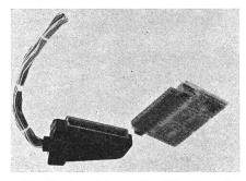
Die Buchsenleiste mit 90° abgewinkelten Kontakten wurde für das direkte Einlöten in Leiterplatten im 2,54-mm-Kontaktabstand ausgelegt. Auf Automaten gedrehte und mehrfach geschlitzte Subminiaturkontakte garantieren grösste Steckfähigkeit sowie höchste Kontaktsicherheit. Die Stiftleiste hat auswechselbare Crimpkontakte, versehen mit einem Metallhalteclip, und kann wahlweise bis 40polig bestückt werden. Der Anschluss wurde für einen Drahtquerschnitt von 0,08 mm² bis 0,6 mm² ausgelegt.
