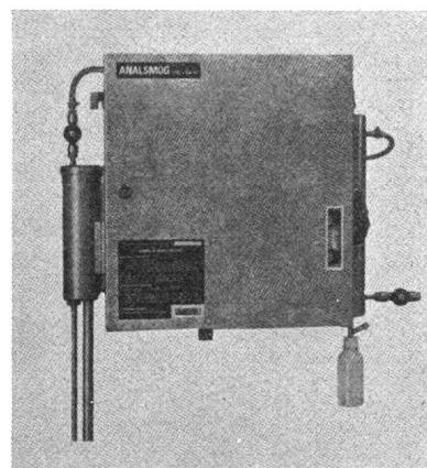
CO- und H<sub>2</sub>-Gehalt nach dem «Wärmeleitfähigkeitsverfahren».
