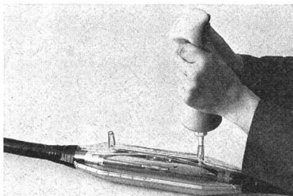
verbindungsmuffen für Niederspannungskabel. Die hohe Haftfähigkeit zu den verschiedenen Kabelmantelwerkstoffen sowie die elektrischen Eigenschaften von K-404/5 bilden die Voraussetzung als Kabelvergussmasse. Außerdem können nicht nur Kunststoffkabel, sondern vor allem dank der Ölbeständigkeit von K-404/5 auch Papierbleikabel einwandfrei vergossen werden.
