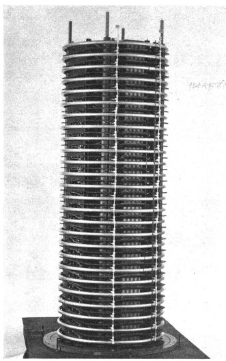
Fig. 9 **2,5-MV-Kompakt-Marxer** 2,8 m Höhe; 13,8 kWs Speicherenergie; 3 μH Induktivität
