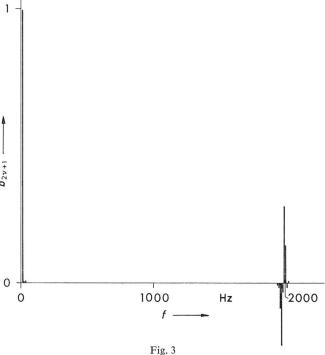
Frequenzspektrum der Pulssteuerung bei konstanter Pulsfrequenz von 2000 Hz für eine Grundwelle der zu erzeugenden Wechselspannung von 10 Hz
