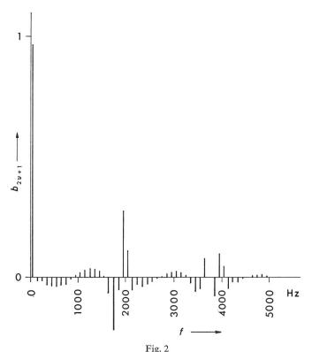
Frequenzspektrum der Pulssteuerung bei konstanter Pulsfrequenz von 2000 Hz für eine Grundwelle der zu erzeugenden Wechselspannung von 50 Hz
