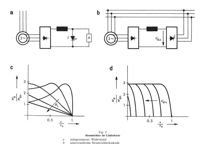
Drehmoment-Drehzahlkennlinie nach Schaltung a
