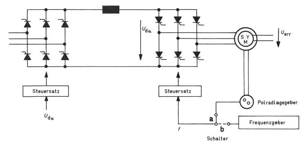
Fig. 6 Umrichtergespeiste Synchronmaschine
