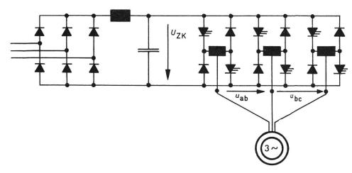
Umrichter mit konstanter Zwischenkreisgleichspannung  $U_{
