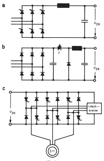
Umrichter mit variabler Zwischenkreisgleichspannung  $U_{ZK}$  zur Speisung von Asynchronmaschinen
