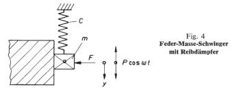
Die Anpresskraft F wird durch die Blattfeder gemäss Fig. 3 erzeugt. Der Betrag des Reibbeiwertes  $\mu_R$  soll für Ruheund Bewegungsreibung gleich gross sein. Die Reibkraft R beträgt dann in beiden Fällen
