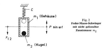
Startet das System, angetrieben durch die Störkraft  $P \sin \omega t$  aus der Ruhelage nach oben, so wird die Kugel  $m_2$  auf den Boden von  $m_1$  gepresst. Es gilt die Bewegungsgleichung
