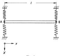
Fig. 6 An den Punkten A und B elastisch und gelenkig gestützter Stab
