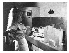
Messgerät dient speziell in nuklearmedizinischen Laboratorien zur schnellen und genauen Bestimmung der Aktivität in den Einheiten μCi und mCi bis zu einem maximalen Messbereich von 100 mCi. Das Gerät besteht aus einer Ionisationskammer und einer Messelektronik.
