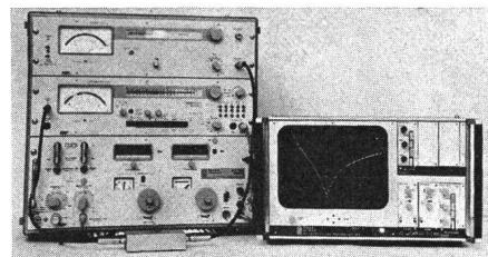
widerstand gemessen; dieser weist hierbei den kleinsten Wert auf, welcher nur von den ohmschen Verlusten bestimmt wird. Die gemessenen Verluste sind demzufolge ein Mass für die Güte des Kondensators. Auf einem Sichtgerät lässt sich der Betrag des Scheinwiderstandes einfach und genau ermitteln. Das Einblenden von Vergleichslinien ermöglicht außerdem das Vorgeben von Toleranzgrenzen.
