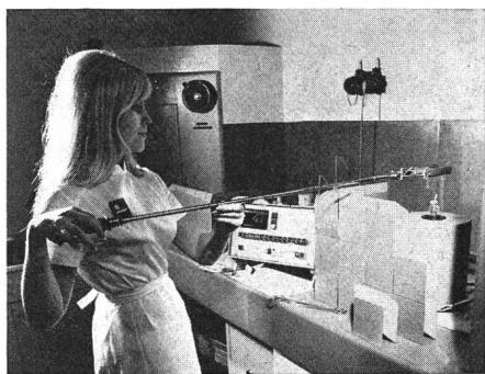
Messgerät dient speziell in nuklearmedizinischen Laboratorien zur schnellen und genauen Bestimmung der Aktivität in den Einheiten  $\mu\text{Ci}$  und  $\text{mCi}$  bis zu einem maximalen Messbereich von  $100 \text{ mCi}$ . Das Gerät besteht aus einer Ionisationskammer und einer Messelektronik.
