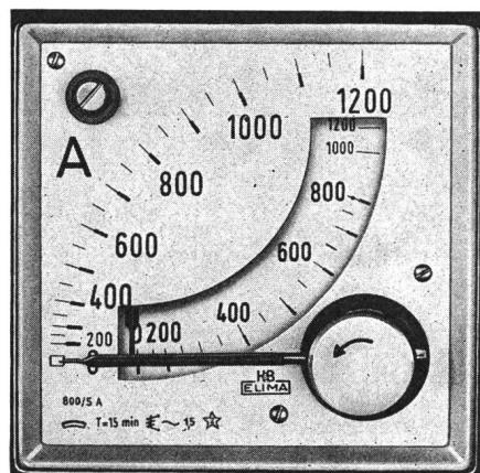
diagonale Anordnung der beiden Messwerke vermuten. Dabei ist die Deckskaala dem Bimetallmesswerk für die Mittelwertanzeige zugeordnet. Die momentanen Stromwerte zeigt das Dreheisensystem an, dessen Skala und Zeiger in dem Ausbruch der Deckskaala sichtbar ist.
