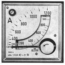
diagonale Anordnung der beiden Messwerke vermuten. Dabei ist die Deckskala dem Bimetallmesswerk für die Mittelwertanzeige zugeordnet. Die momentanen Stromwerte zeigt das Dreheisensystem an, dessen Skala und Zeiger in dem Ausbruch der Deckskala sichtbar ist.
