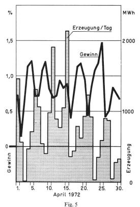
Ergebnis der fiktiven Optimierung im Kraftwerk Mayrhofen
