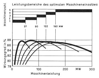
Fig. 2 Anlagenwirkungsgrade des Kraftwerkes Mayrhofen
