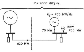
Fig. 10 Parallelbetrieb zwischen einem grossen und einem kleinen Netz Bezeichnungen siehe im Text
