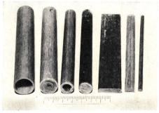
durch extrem hohe Festigkeit in Faserrichtung und Unempfindlichkeit gegen ungünstige klimatische Einflüsse aus. Derartige Profile sind elektrisch isolierend, mechanisch bearbeitbar und können im Normalfall bis zu Temperaturen von 150 °C dauernd eingesetzt werden. Solche Profile eignen sich zum Beispiel als Rotor- und Stator-Nutenkeile für Elektromaschinen und als Schalt- und Zugstangen für die Betätigung von Apparaten. Sie können in den verschiedensten Querschnitten hergestellt werden.
