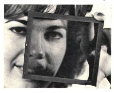
cm² können leicht erreicht werden. Die Löcher können quadratisch, rechteckig, rund oder anders geformt sein. Die porösen Platten sind zur besseren Kontrastierung dunkel purpurn gefärbt. Die porösen Platten werden chemisch aus einem Glas geätzt, das ultraviolettempfindlich ist.
