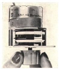
Verfügung. Auf der genormten Einstellachse kann ein Drehknopf befestigt werden, welcher zugleich als Funktionsanzeige dient. Der Handzeitschalter ist für eine Schaltleistung von 16A/380 V∼ konstruiert. Bei Spannungsausfall wird der Ablauf angehalten und bei Spannungsrückkehr wieder fortgesetzt.
