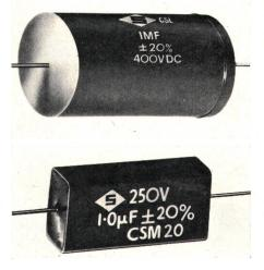
spannung aus. Der Verlustfaktor tanð ist geringer als 0,003 bei 1 kHz. Der Isolationswiderstand für beide Serien beträgt mindestens 60 000 M $\Omega$  bei einer Kapazität von kleiner als 0,47  $\mu$ F; bei Kapazitäten grösser als 0,47  $\mu$ F beträgt er 20 000 M $\Omega$  pro  $\mu$ F. Die zulässige Arbeitstemperatur liegt zwischen –55 und +85 °C.
