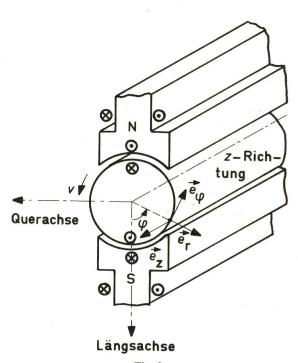
Fig. 2 Schematische Darstellung einer zweipoligen Gleichstrommaschine im Zylinderkoordinationssystem, bei Motorbetrieb
