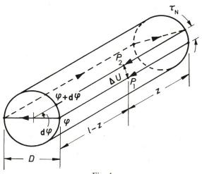
Fig. 4 **Bestimmung der** Eφ-**Komponente**Bezeichnungen siehe im Text
