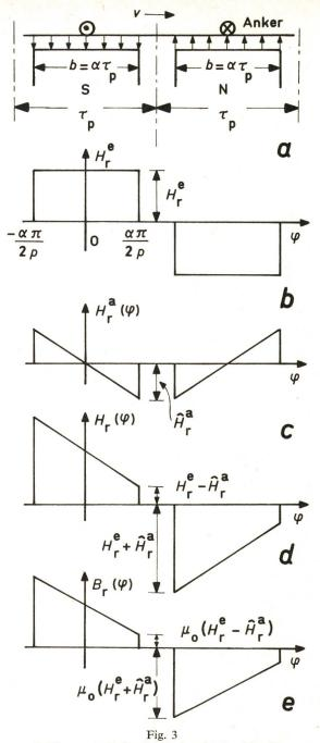
Feldkurven im Luftspalt bei abgewickelter Maschine
