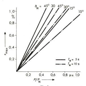
Fig. 2 Grenzschlupf  $s_{\max}$  in Abhängigkeit vom zuverlässigen Wirklaststoss  $P/P_N$  Parameter: Polradwinkel bei Nennnlast  $\vartheta_N$  Anlaufzeitkonstante  $T_a$
