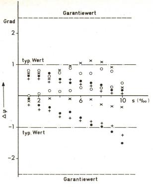
$\begin{array}{c} {\rm Fig.~6} \\ {\rm Fehlwinkel~} \Delta \varphi {\rm ~als~Funktion~von~Schlupf~} s \\ {\rm und~Schaltereigenzeit~} t_{\rm S} \end{array}$
