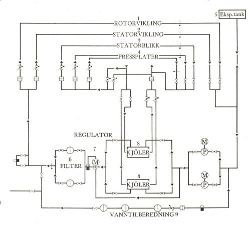
Fig. 11 Kühlwasserschema
