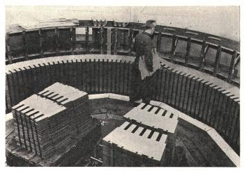
Fig. 7 Einlegen der Statorbleche mit Nuten für die Kühlrohre
