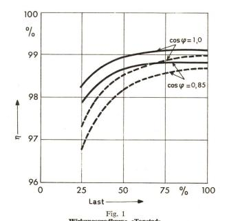
Wirkungsgradkurve «Tonstad» 190 MVA, 375 U./min, 120 kV, 50 Hz
