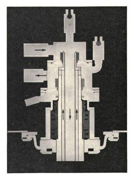
Fig. 10 Kühlwasserzuführung
