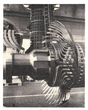
Fig. 10 Dämpferwicklung für Turbogeneratoren
