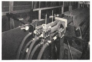
Fig. 7 Modell für die Prüfung von Statorstäben für Turbogeneratoren grösser als 1000 MW
