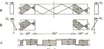
Fig. 8 Roebelstab mit 360° Verdrillung im Nutenteil und 180° Verdrillung im Wickelkopf
