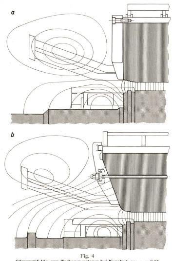
Stirnraumfelder von Turbogeneratoren bei Nennlast,  $\cos \varphi = 0.85$ a Blechkörper mit vollständig abschirmender Pressplatte b Blechkörper mit konischer, lamellierter Pressplatte nach Darrieus
