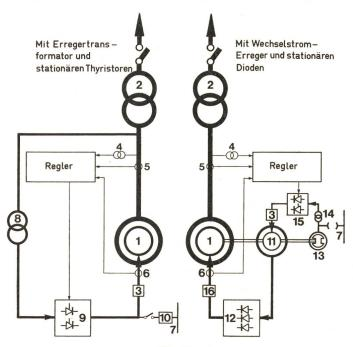
Fig. 11 Erregersysteme für grosse Turbogeneratoren
