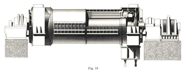
Vierpoliger Turbogenerator 1333 MVA, 26 kV, 1800 U./min Statorwicklung wassergekühlt, Rotorwicklung wasserstoffgekühlt
