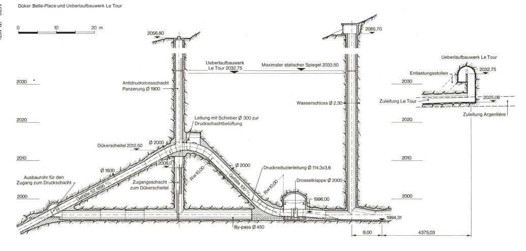
Wassermenge. Der Syphon funktioniert deshalb je nach der Wassermenge nicht immer gleich.
