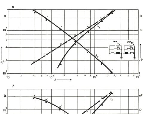
Fig. 8 Parallelwiderstand  $R_{\rm p}$  und Parallelkapazität  $C_{\rm p}$  in Abhängigkeit vom Schaltstrom I
