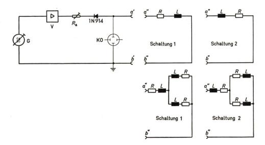
Fig. 2 Schaltschema für die Ermittlung der Parameter der natürlichen Einschwingspannung
