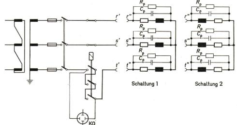
Dämpfung der Einschwingspannung  $u_e$  konstant, verglichen mit dem Anstossverfahren. Der zeitliche Verlauf von  $u_e$  ist jedoch unter dem Einfluss des Schaltlichtbogens statistischen Streuungen unterworfen. Es sind anhand von Fig. 12 zwei Überschwingfaktoren zu unterscheiden. Das Verhältnis Scheitelwert  $\hat{u}_e$  der Einschwingspannung zu Momentanwert  $\hat{u} \cdot \sin \varphi$
