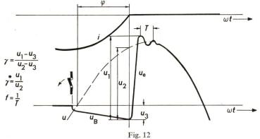
Definition der Überschwingfaktoren unter Berücksichtigung der Lichtbogenspannung
