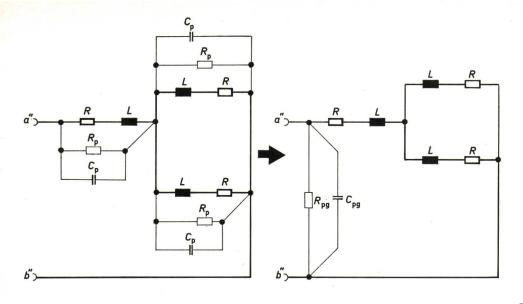
Fig. 11 Schaltschema für die Ermittlung der durch den Lichtbogen beeinflussten Einschwingspannung
