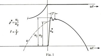
Definition des Überschwingfaktors  $\gamma^*$  und der Frequenz fder natürlichen Einschwingspannung  $u_a^*$
