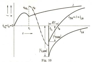
Prinzipielle Strom (i) und Spannungsverläufe (u) der Löschschaltung mit Löschthyristor nach Fig. 4
