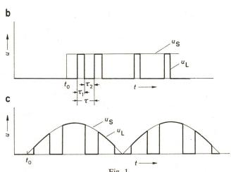
Thyristoranordnung mit Zünd- und Löscheinrichtung (a) zur Erzeugung von geeigneten Spannungsimpulsen für Gleichstromstellung (b)
