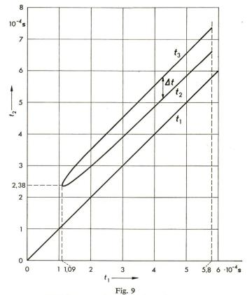
Verläufe von  $t_2$  und  $t_3$  und somit von  $\Delta t = t_3 - t_2$  (der zur Verfügung stehenden Schonzeit) für die Schaltung nach Fig. 3 in Abhängigkeit von  $t_1$ , dem Zeitpunkt der ersten Zündung des Thyristors nach Anlegen der Speisespannung zur Zeit t=0
