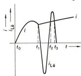
Verlauf des Laststromes i und des Löschstromes  $i_{\text{L}, \ddot{0}}$ für die Schaltung nach Fig. 3
