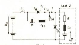
Fig. 3 Löschschaltung mit Umschwingdrosselspule  $L_{
