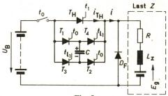
Fig. 5 Typische Gegentaktlöschschaltung mit Hilfsthyristoren  $\mathbf{T}_1$  bis  $\mathbf{T}_4$  für Gleichstromsteller
