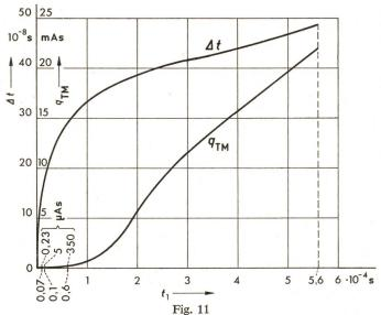
Veränderung der für die Schaltung nach Fig. 4 maximal zur Verfügung stehenden Schonzeit und maximal beherrschbare Sperrverzugsladung  $q_{\rm TM}$  in Abhängigkeit von  $t_1$ , dem Zeitpunkt des ersten Zündens von  ${\rm T_H}$   $(q_{\rm TM} < 0 \ {\rm für} \ t_1 < 1, 6 \cdot 10^{-8} {\rm s})$
