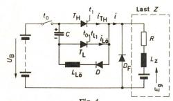
Fig. 4 Löschschaltung mit Löschtyristor  $\mathbf{T}_{L}$  für Gleichstromsteller
