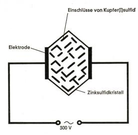
Fig. 2 Verteilung der Elektrolumineszenz-Leuchtlinien im Zinksulfidkristall
