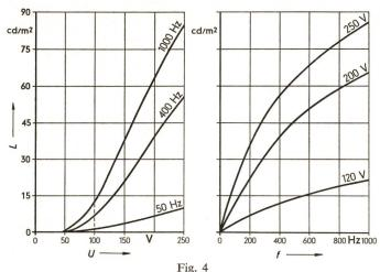
Leuchtdichte einer Elektrolumineszenz-Lichtquelle in Abhängigkeit von der angelegten Betriebsspannung sowie der Betriebsfrequenz
