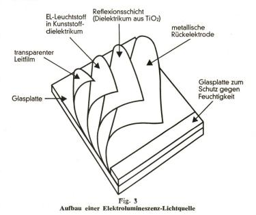
Verschiedenartige Lumineszenzfarben kann man auch dadurch erzeugen, dass man dem Elektrolumineszenzleuchtstoff fluoreszierende Tageslichtleuchtstoffe beimischt, die z. B. rotes Licht emittieren, wenn sie mit grünem Elektrolumineszenzlicht angeregt werden. Regt man mit blauer Elek-
