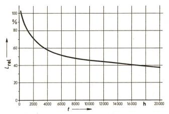
Fig. 5 Alterung einer Elektrolumineszenz-Lichtquelle. die am Lichtnetz betrieben wird  $L_{
