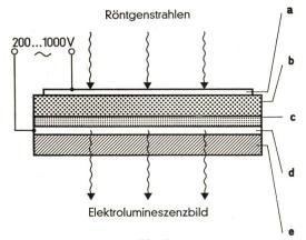
Fig. 9 Aufbau eines Festkörperbildwandlers
